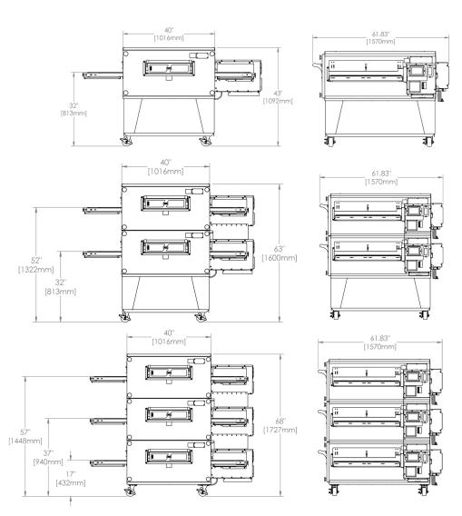
\*A MINIMUM OF A 1½" GAS SUPPLY LINE IS REQUIRED. THE GAS LINE MUST BE PLACED TO THE SIDE OF THE OVEN AND CANNOT BE BEHIND THE CONTROL BOX.
